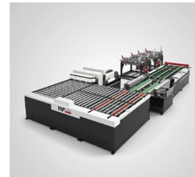
Dây chuyền sản xuất ống gió tự động. Model: AML-1300-U
